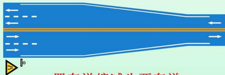
四车道缩减为两车道
