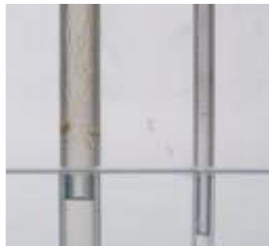
由于液体浸润管壁，液面呈图所示的形状，液面弯曲。液体表面张力形成向上的拉力，这个力使管中液体向上运动。
