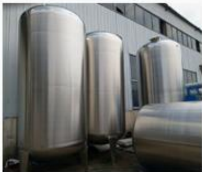
(a) 不锈钢储存罐
