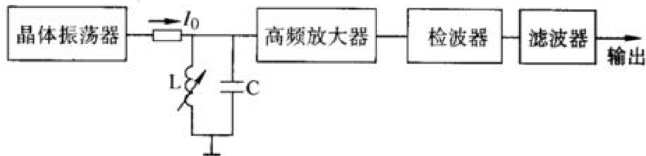
调幅式测量电路原理框图
